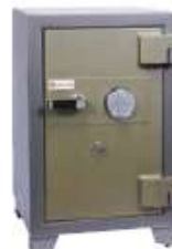
■ GH-5C 外部尺寸:H850xW515xD565(mm) 門栓直徑:φ30(mm) 重量:160kgs 隔板:2pcs
